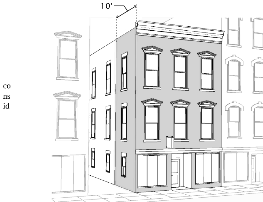
Façade Material Wrap
